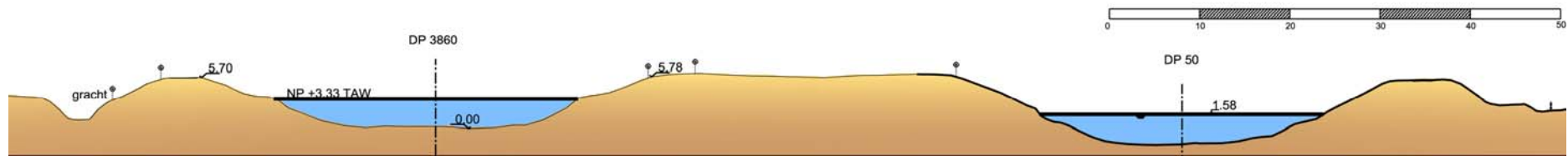
Dwarsprofiel in pand Damme-Strobrugge, georiënteerd van linker- naar rechteroever, hoogtes in m TAW, maten op horizontale schaalbalk in m
